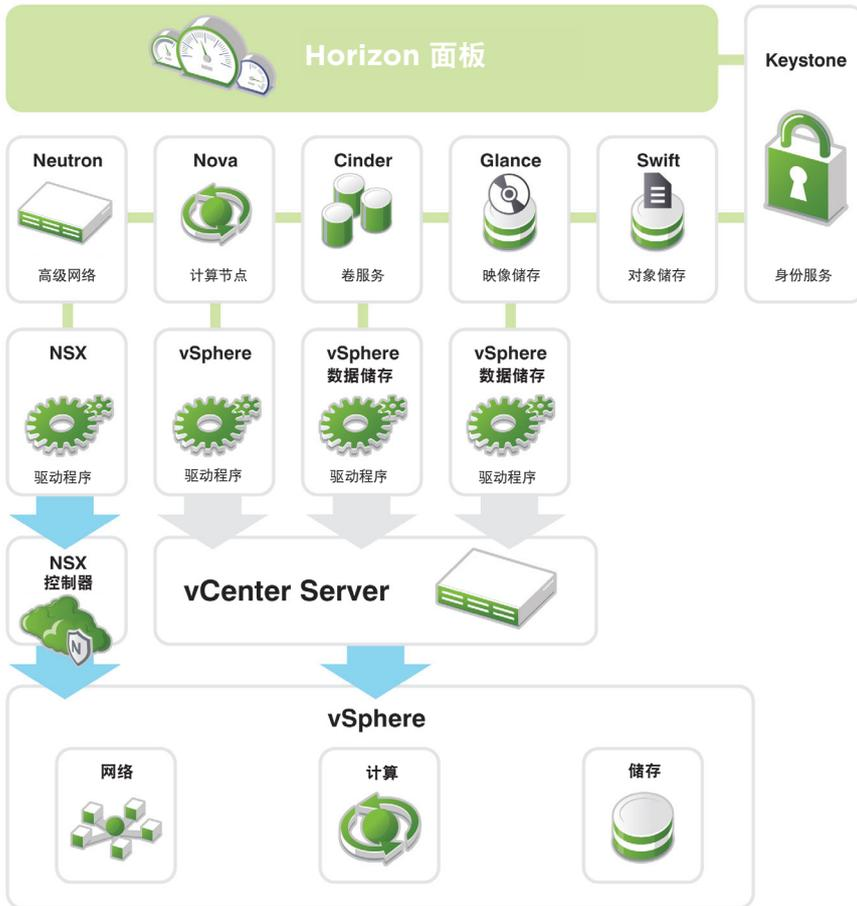
SUSE Cloud 通过 VMware vCenter 为 OpenStack 与 VMware 环境集成提供全面支持。VMware vCenter 继续管理 VMware 虚拟环境, SUSE Cloud 则管理私有云的整体活动。就像 VMware vSphere 为虚拟基础设施提供高可用性 (HA) 一样, SUSE Cloud 经过配置, 也可以为 OpenStack 控制平台提供 HA。这一运营框架使 IT 部门得以利用其目前的 VMware 虚拟化环境和技能, 在向基于 OpenStack 的私有云转换的过程中实现投资最大化。
